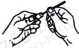
Мал. 19 Видаліть нагар з корпусу форсунки
