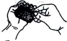
Мал. 20 Видаліть нагар із голчастого клапана
