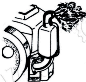
Мал. 13 Вихлопний газ чорного кольору
