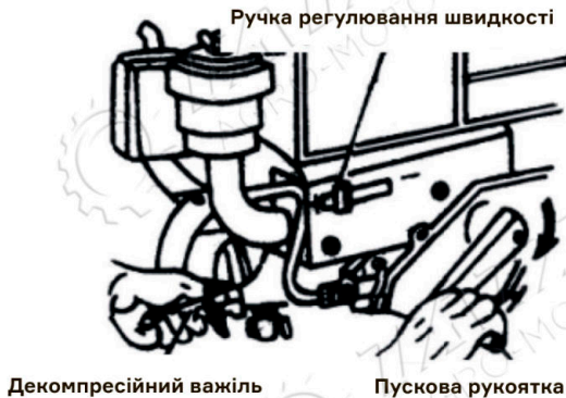
Мал. 11 Запуск двигуна за допомогою ручної пускової рукоятки
