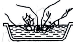
Мал. 21 Промийте корпус форсунки та голчастий клапан
